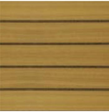
Este elemento, utilizado desde hace mucho tiempo es un clásico entre los productos acústicos. Después de casi 20 años en el mercado, continúa siendo solicitado y apreciado. La superficie del panel alveolado por extrusión de 24 mm de espesor está atravesada, hasta los tubos internos, por ranuras regulares de 4 mm de ancho. Así, el aspecto de los revestimientos de paredes y de techos está formado por líneas finas y discretas.
